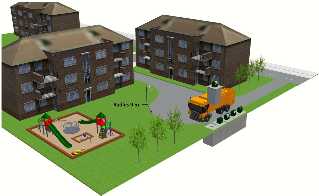
Mynd 5: Lágmarksstærð snúningssvæðis fyrir hirðubíl
