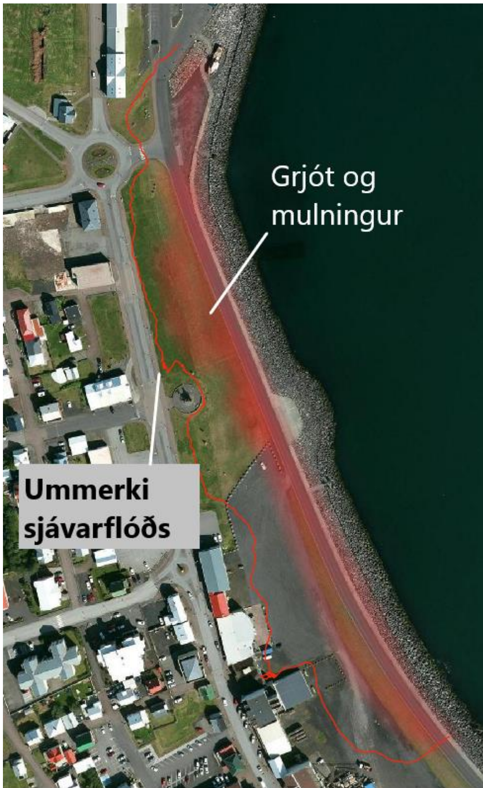
Mynd 7 Miðbær Keflavíkur þar sem sjór gekk yfir varnargarð við Ægisgötu, grjót barst yfir götuna, bundið slitlag losnaði á hluta hennar (fyrir framan grasflötina), auk þess sem vatn flæddi inn bílastæði við Hafnargötu og flæddi inn á jarðhæð/kjallara húsa sem standa við götuna, t.d. á veitingastaðnum Ráin. Rauða svæðið sýnir hvar grjótmulningur var í nokkru magni.
