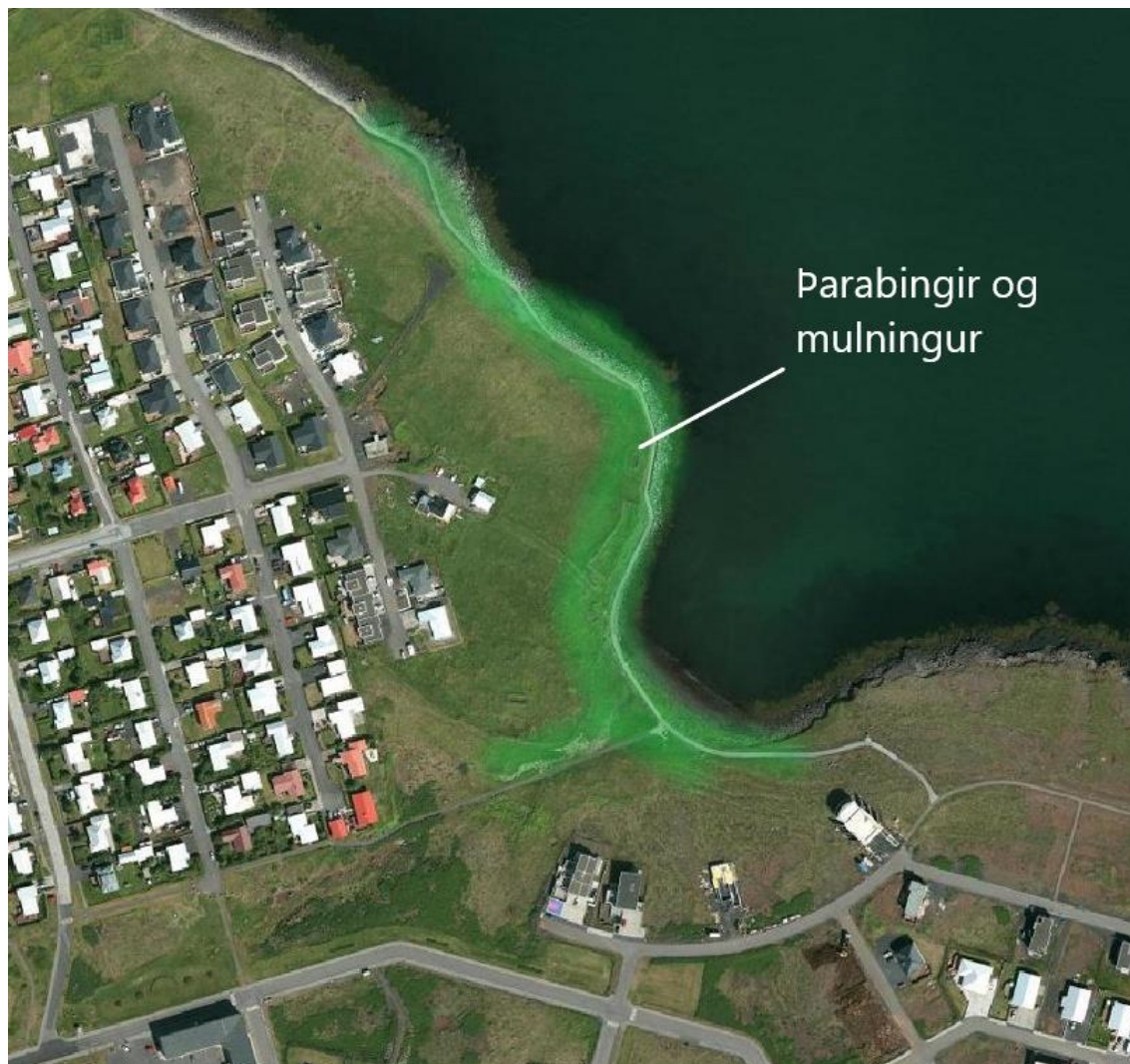
Mynd 1 Yfirlitsmynd frá vögnum Kópa þaðan sem er göngustígur inn að Njarðvík samhliða sjóvarnargarði. Nokkuð hafði skolast af þara yfir varnargarðinn (sjá grænlistað svæði), og grjótmulningur úr honum hafði farið yfir stíginn, en þó óvíða meira en örfáa metra inn á land.
